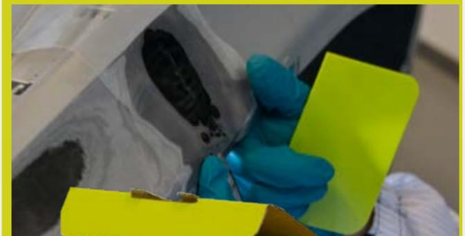
**08 SAND THE SURFACE CREATED BY THE PLASTIC REPAIR**
